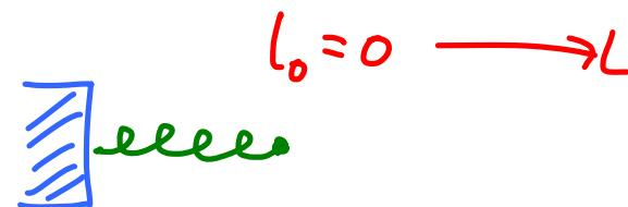
Federspannkraft  $F_{\text{Spann}} = -k \cdot L$  muss überwunden werden:  $W = F_0 \cdot \Delta L_0 + F_1 \cdot \Delta L_1 + \dots$
