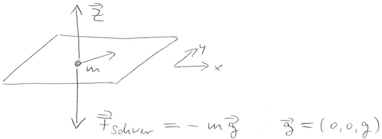
ZB  $z=0$  realisiert durch Zwangskraft (ZK)
