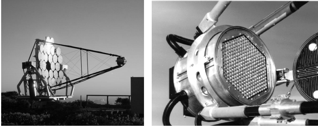
Abbildung 2.5: Links: Das HEGRA-Cherenkov-Teleskop CT2. Zu erkennen ist die Anordnung der Einzelspiegel im Davies-Cotton-Design, die PM-Kamera in der Fokalebene, sowie die Aufhängung in der Altitud- und Azimut-Achse. Im unteren, rechten Teil des Bildes ist die Hütte mit der Auslese- und Steuerungselektronik zu erkennen. Rechts: Die geöffnete Kamera, in der sich die 271 hexagonal angeordneten Photomultiplier befinden.
