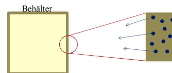
Diffusion von H durch die Wand an die Oberfläche, „Abdampfen“ ins Vakuum
