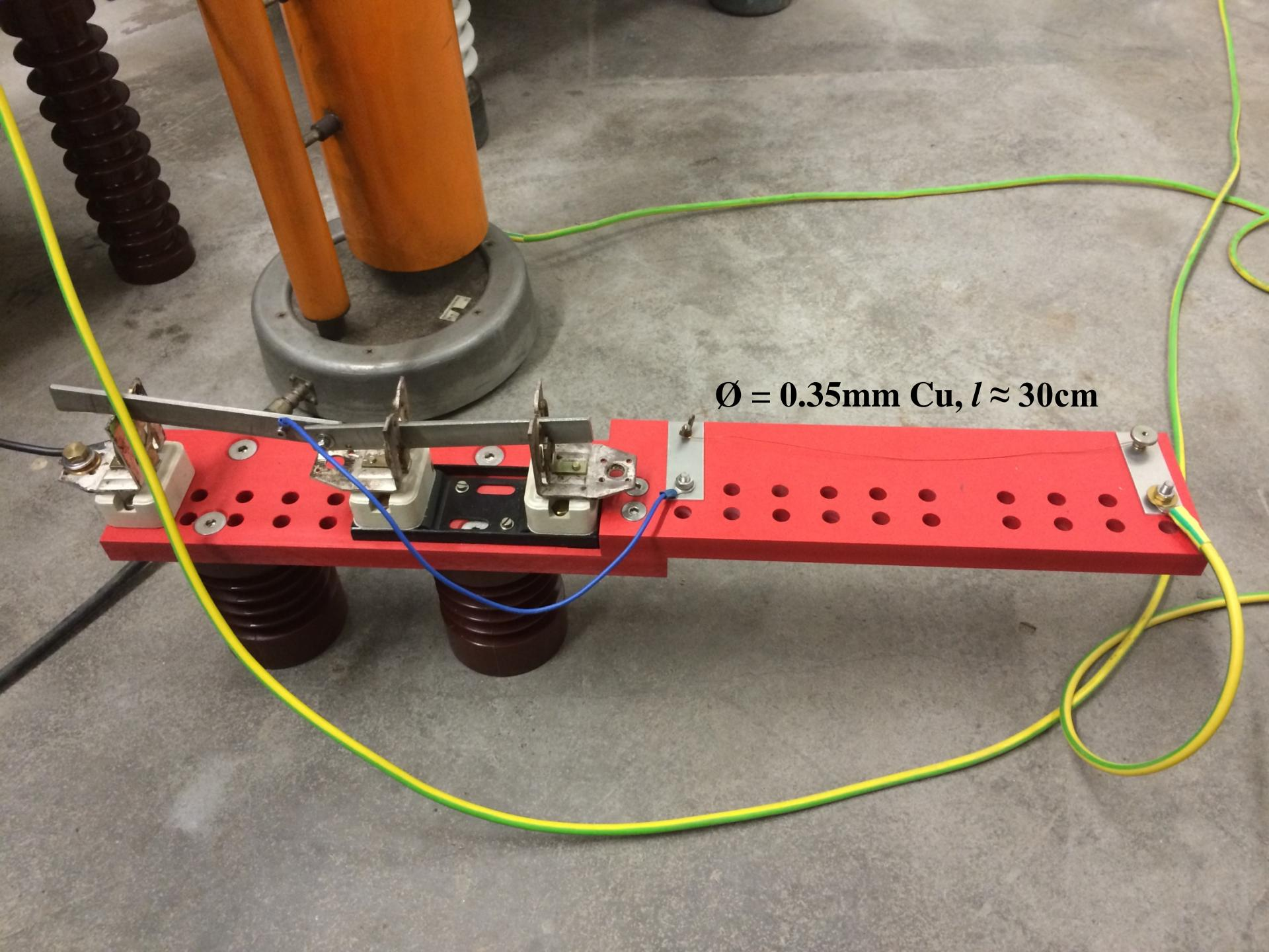
$\varnothing = 0.35\text{mm Cu}, l \approx 30\text{cm}$
