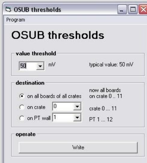
Die Schwellen werden per OSUB auf Vorverstärkerplatinen an den Driftröhren gespeichert und Rauschen dadurch herausgefiltert.
