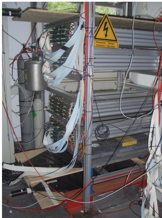
Abbildung 6.1: Der Testaufbau von vier Modulen mit nur 1 m langen Röhren im Labor am Institut für Experimentalphysik in Hamburg
