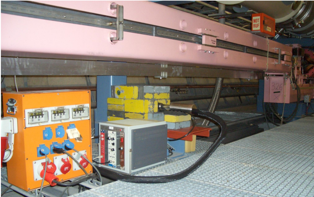
Abbildung 6.1.: Bild vom Detektor im Tunnel. Der Detektor liegt in der 10 cm dicken Bleiburg. Das Myonveto ist hier noch nicht installiert.
