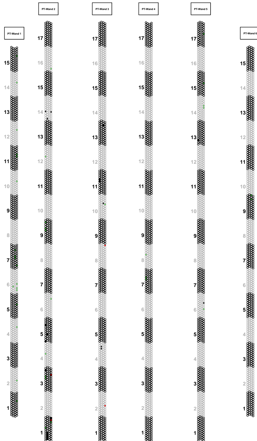
Abbildung 3.5: Darstellung aller problematischen Kanäle im ersten Supermodul in einer Aufsicht auf den Precision Tracker (6 PT-Wände mit 17 bzw. 15 Modulen). Rauschende Kanäle sind rot, tote Kanäle schwarz und Kanäle mit Übersprechen grün gekennzeichnet. Nur vereinzelt sind einige Röhren nicht mehr voll funktionsfähig.
