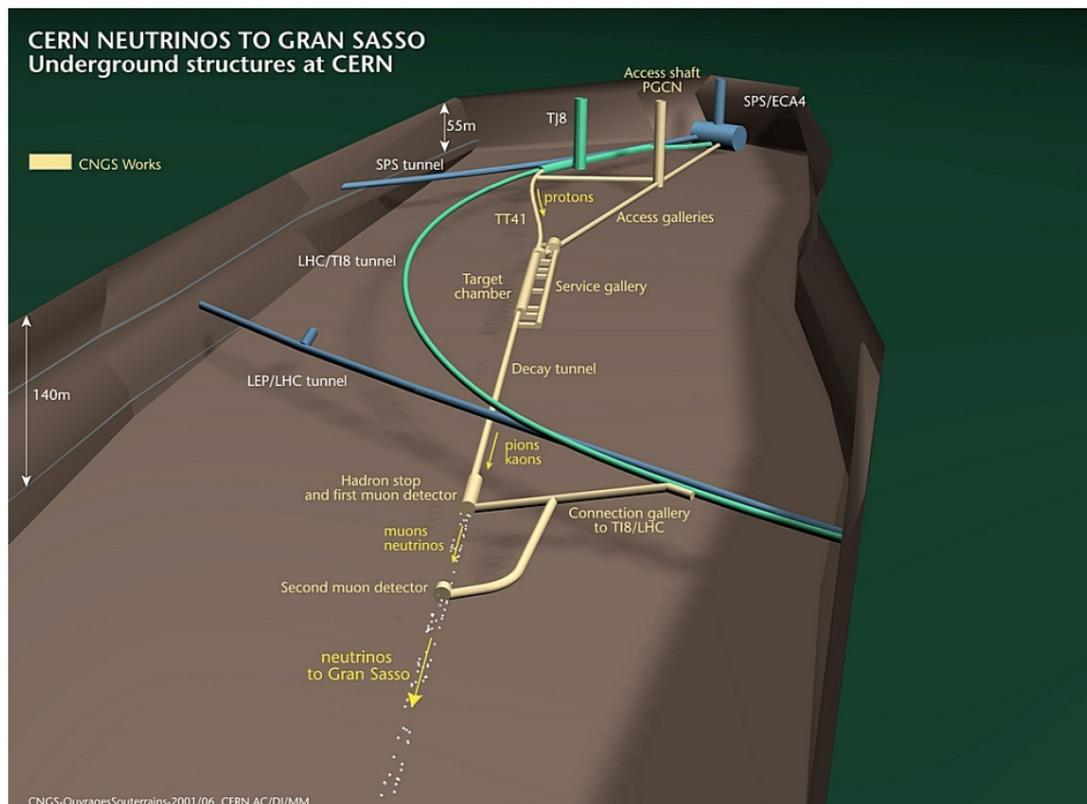
Abbildung 3.5: Unterirdische Anlage am Cern; Gelb: Neutrinoquelle; Hellblau (oben): SPS-Tunnel; Dunkelblau (unten): LEP/LHC-Tunnel [Cern]
