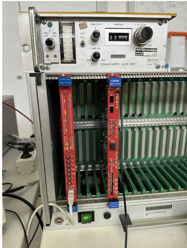
**Abbildung 4.7** Der verwendete VME-Standard mit einem VME USB2.0 Bridge Modul (links) und einem FADC Modul (rechts). Oben auf dem VME Oberrahmen befindet sich das Hochspannungsgerät.
