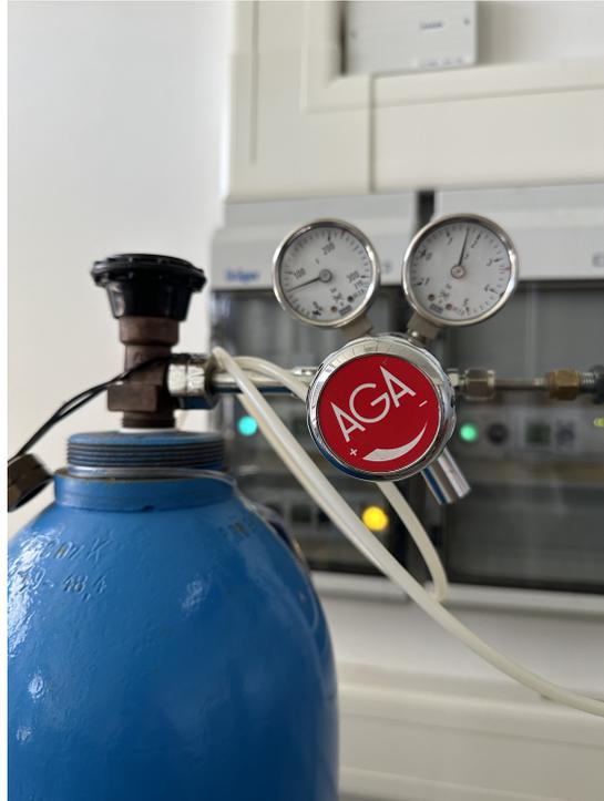
Abbildung 4.4 ArCO<sub>2</sub> Gasflasche und System zur Reduzierung des Gasdrucks durch einen Druckminderer.
