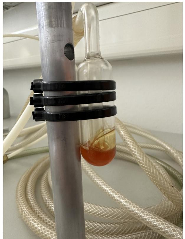
Abbildung 4.6 Foto des verwendeten Bubblers.
