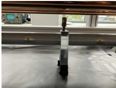
Abbildung 3.3: Bild der Driftröhre mit ^{55}\text{Fe} in einer Halterung über einem Loch.
