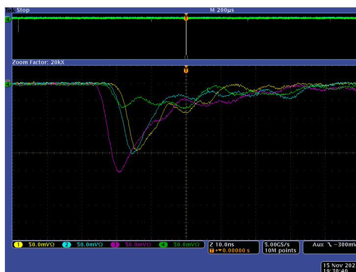
Abbildung 5.1 Gemessenes Signal der vier PMTs beim Auftreffen eines Myons auf der Szintillatorplatte aufgenommen mit einem Oszilloskop.
