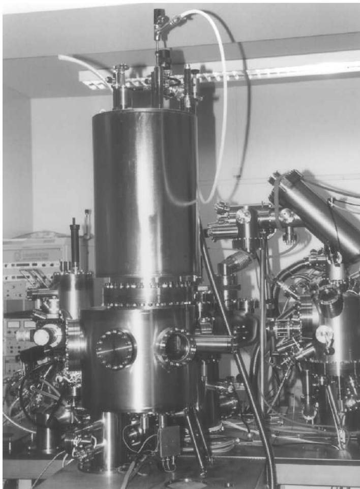
**Abbildung 3.1:** Ansicht des KammerSystems mit der neuen Vakuumkammer im Vordergrund. Der obere Zylinder beherbergt die Reservoirs für Helium und Stickstoff. Unterhalb der UHV-Kammer sind die elektrischen Zuführungen und der  $I/U$ -Wandler zu sehen.
