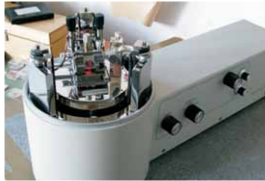
Abb. 2: Ein kommerzielles Rastersondenmikroskop wird für die reale Durchführung von Nanomanipulationen verwendet.
