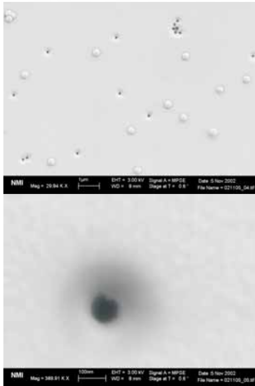
Abb. 2: Nanoporen mit einem Durchmesser von 80 nm für markierungsfreie Analysen.
