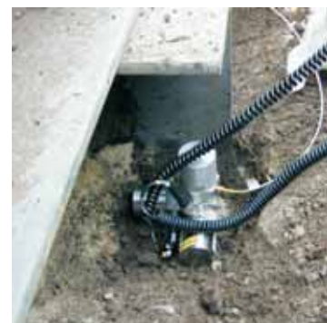
Abb. 5: Schwingungsmessung: Ist der Baugrund für die "Nano-Fab" geeignet?
