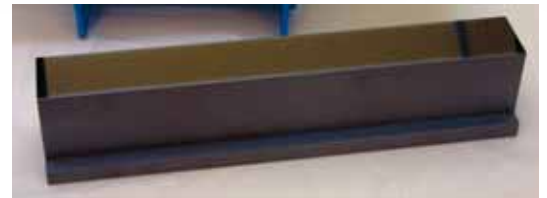
Abb. 2: Optisches Element für den Freie-Elektronen-Laser (FEL) am DESY (Hamburg): 45 nm dicke Kohlenstoffbeschichtung auf planem, 300 mm langem Siliziumeinkristall (T-Profil).
