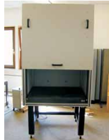
Abb. 3: Lichtdichter Faradaykäfig mit integrierter Schwingungsdämpfung
