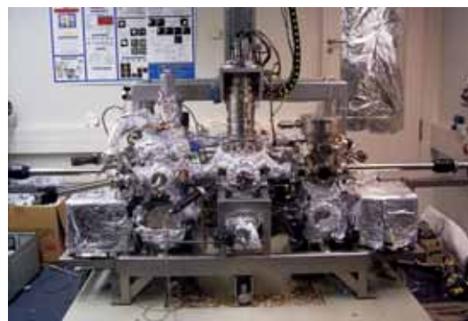
Abb. 3: Für extrem präzise Nanomanipulationen (z. B. Manipulationen einzelner Atome) wird ein mit flüssigem Helium gekühltes Rastersondenmikroskop aus der Arbeitsgruppe von Prof. Wiesendanger am Institut für Angewandte Physik verwendet. Das Mikroskop kann sowohl vor Ort als auch ferngesteuert vom Fachbereich Informatik betrieben werden.
