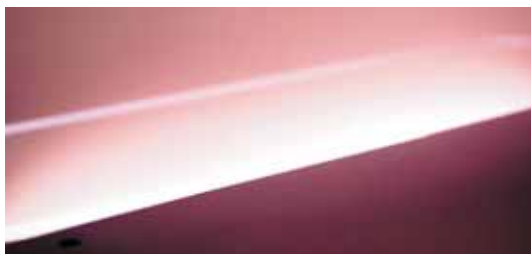
Abb. 1: Plasma in einer Sputteranlage für Präzisionsbeschichtung. Die Quelle misst 30 x 9 cm 2 .
