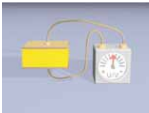
Ein Piezokristall verformt sich, wenn eine elektrische Spannung angelegt wird.
