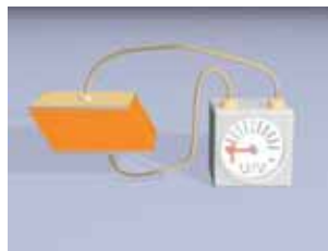
Ein Piezokristall verformt sich, wenn eine elektrische Spannung angelegt wird.
