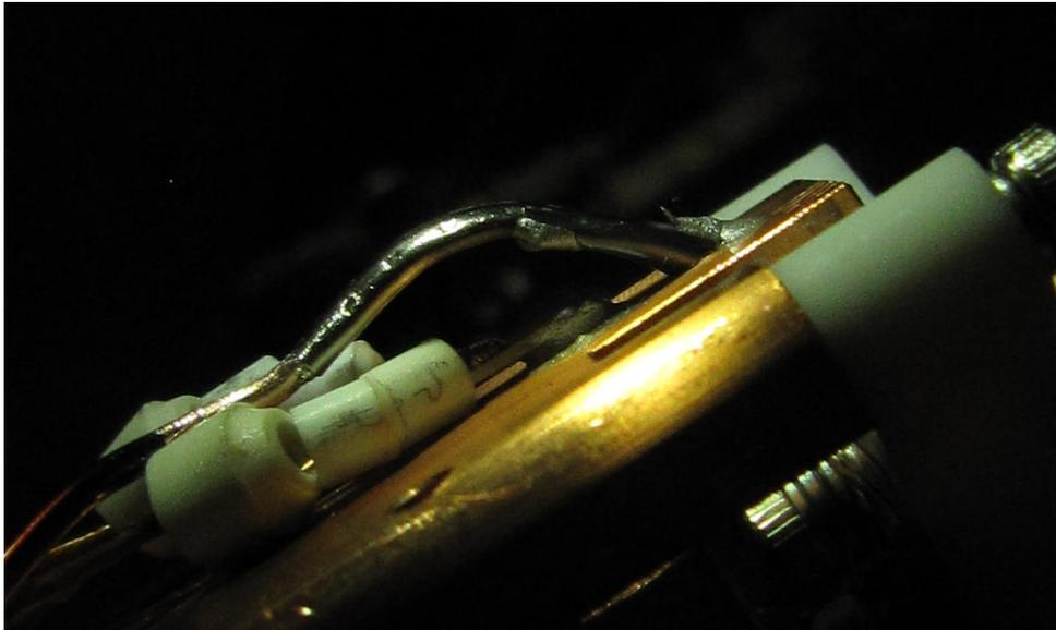
Abbildung 4.11: Sicht von oben auf den Ofen. Nach einem starken Aufheizen degenerierte ein Teil des Vakuumklebers und löste sich vom Ofen (Mitte rechts). Der Druck in der Vakuumkammer stieg dabei auf  $1 \cdot 10^{-6}$  mbar an.
