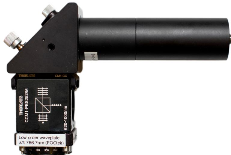
**Abbildung 3.8:** MOT-Auskoppler, bestehend aus einem Faserkoppler, einer Linse ( $f = 100$  mm) zum Kollimieren des Strahls, einem Spiegel zum Justieren, einem Strahlteilerwürfel für eine saubere Polarisation und einem  $\lambda/4$ -Plättchen.
