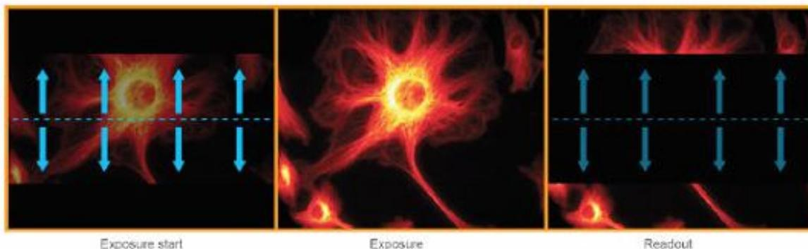
**Abb. 39: Bildaufnahme im „Rolling shutter mode“**
