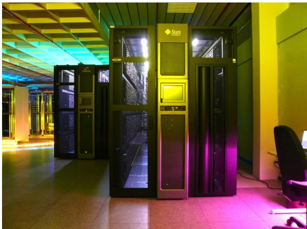
Abb. 1: DESY-Rechenzentrum: Bandroboter
